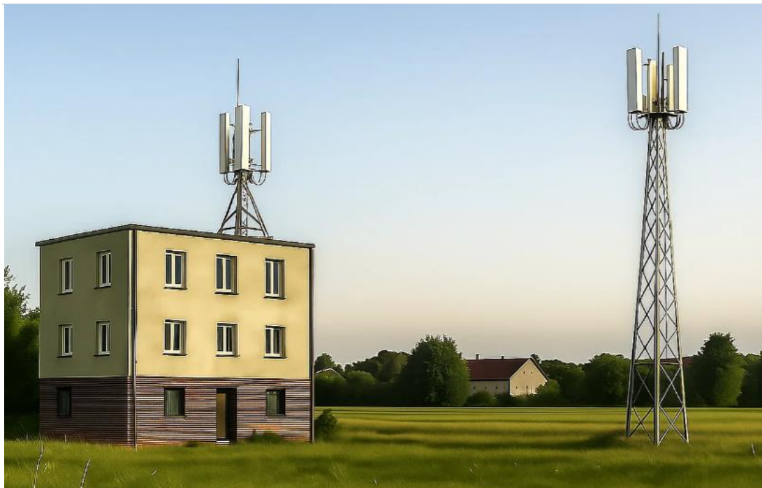
Rysunek 3. Stacje bazowe telefonii komórkowej: zainstalowana na dachu budynku oraz wolnostojąca Źródło: opracowanie własne
